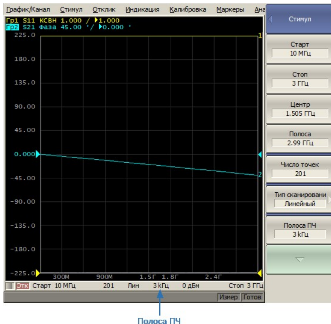
Рисунок – Полоса пропускания ПЧ в строке состояния канала
