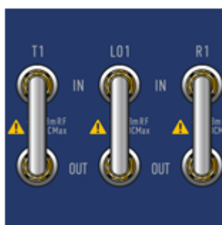
Рисунок – Расположение дополнительных разъемов анализатора C4420
