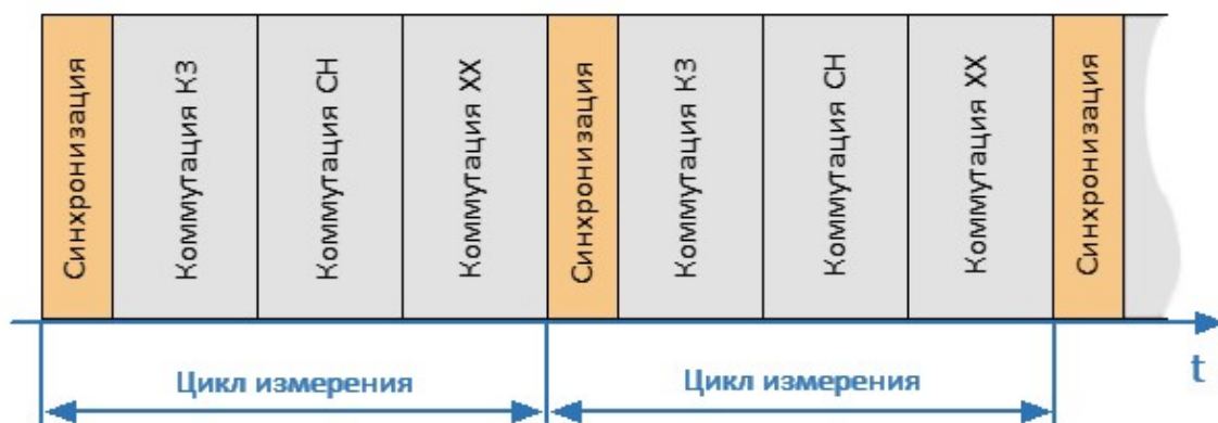
Рисунок – Временная диаграмма рабочего цикла модуля
