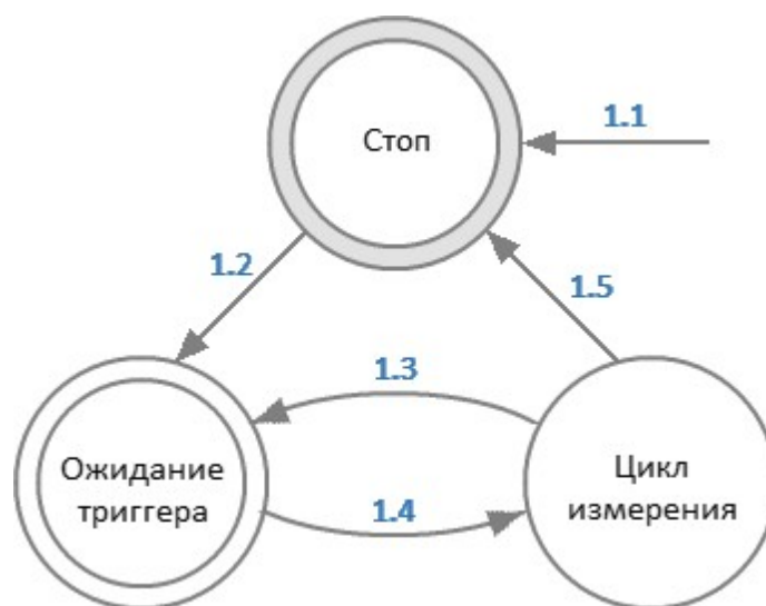
Рисунок — Состояния и переходы анализатора
