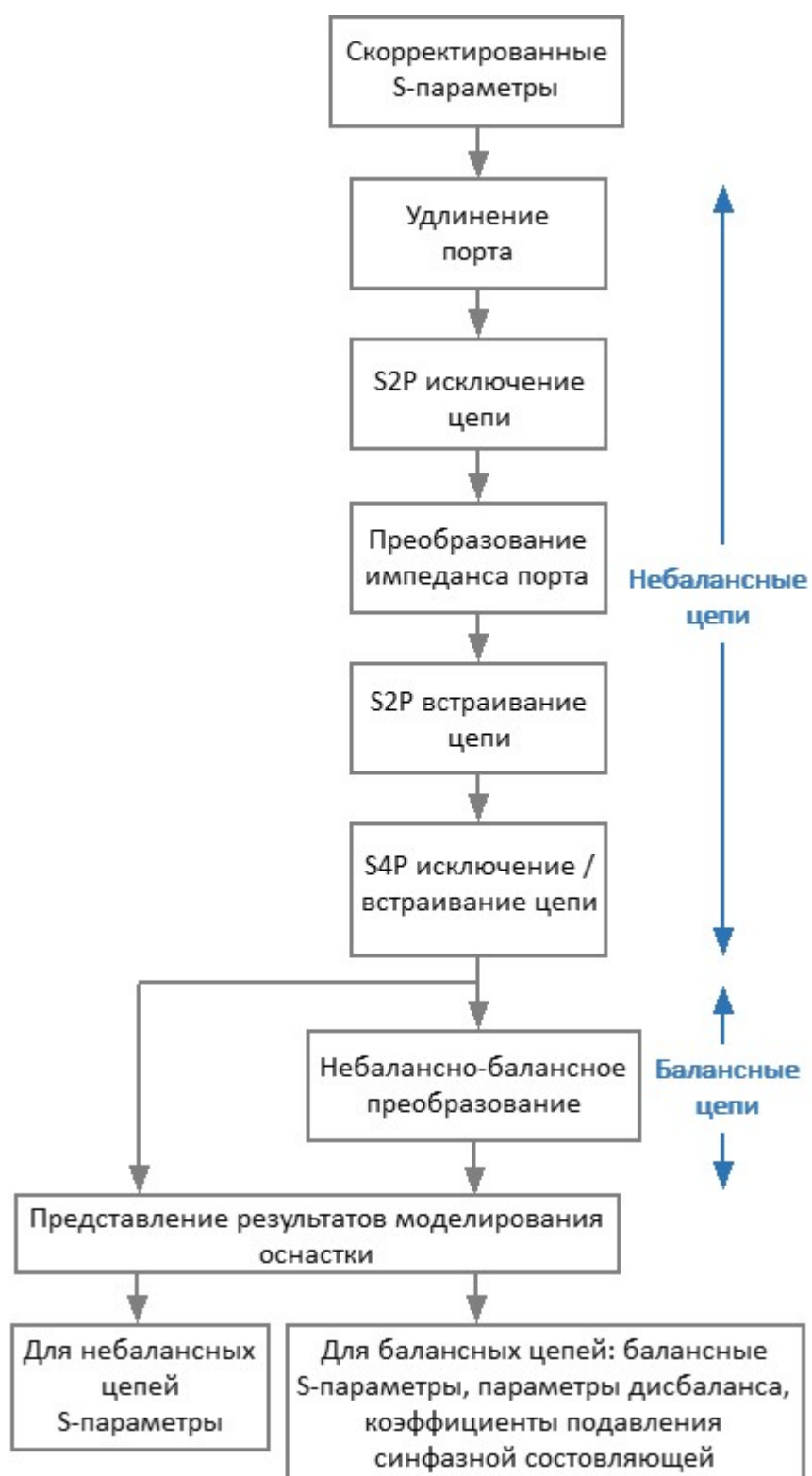
Рисунок – Блок-схема обработки данных при моделировании оснастки
