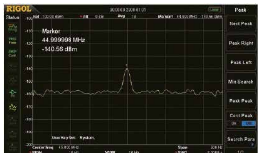
Измерение сигналов с малой амплитудой с включенным предусилителем
