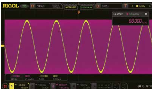
Измерение частоты встроенным частотомером
